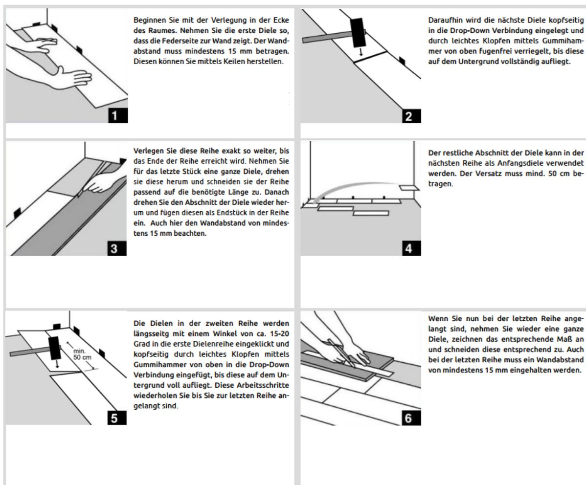
Nach der Verlegung die Wandabstandskeile wieder entfernen und zur Abdeckung der Dehnungsfugen Sockelleisten an der Wand montieren.
