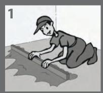
Der Boden muss bis auf 2 mm genau eben sein.
