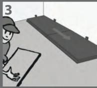
Montieren Sie die erste Reihe in Sonnenrichtung unter Einhaltung des vorgeschriebenen Raumabstands bei allen wänden und elementen. Verbinden Sie die Dielen mit dem Uniclic-System.
