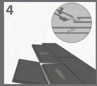
Stecken Sie die Uniclic-Verbindungen der langen Paneelseite im 45° zusammen & drücken es anschließend mit etwas Druck nach unten.
